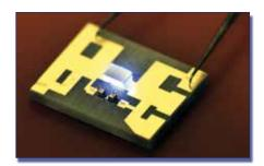
**Fig. 2:** UV LED flip-chip mounted on a AIN-substrate Source: CiS Forschungsinstitut für Mikrosensorik GmbH
